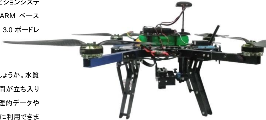
IDS USB 3.0 産業用カメラと ARMv7 シングルボードコンピューターを搭載したマルチコプター
